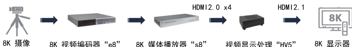
图：由 e8 视频编码器、s8 媒体播放器及 HV5 视频显示处理器组成的视频直播系统
