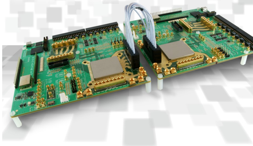
写真 1: 「Celtic-Plus SASER」プロジェクトのために設計されたソシオネクストの ADC/DAC 開発キット ( 拡大イメージ )
