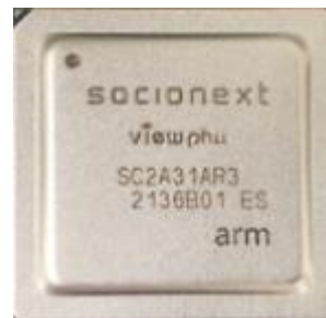
超音波画像生成 LSI (23mm × 23mm)
